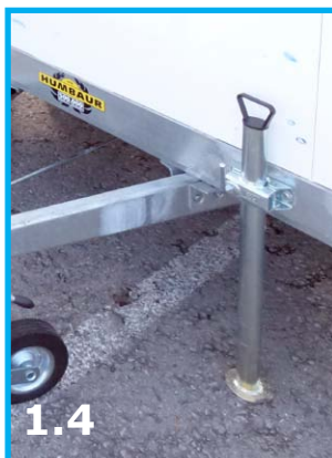
1.4 Füße an Vorderseite auf Boden hinunterlassen
