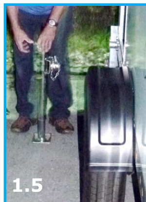
1.5 Füße an Rückseite in Aufnahmebuchsen setzen · mit Sicherheitsstiften fixieren
