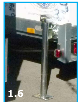
1.6 Füße mit Sechskantschlüssel bis auf Boden drehen
